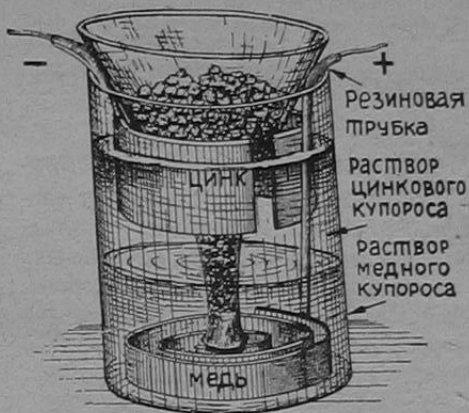
Рис. 3. Элемент типа Мейдингера (самодельный).
